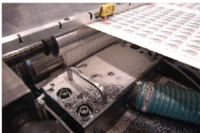
Feinster Papierstaub ist während der Schleifperforation trotz Staubabsaugung nicht zu vermeiden.
